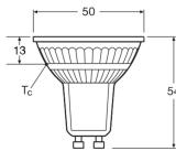
Technische Daten Ledvance Superior LED-Spot Reflektor GU10 PAR16 4.5W 350lm 36D - 818-827 Dim to Warm | Dimmbar - Ersatz für 50W
